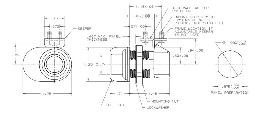
PULL TAB MAY BE INSTALLED 180° FROM POSITION SHOWN
