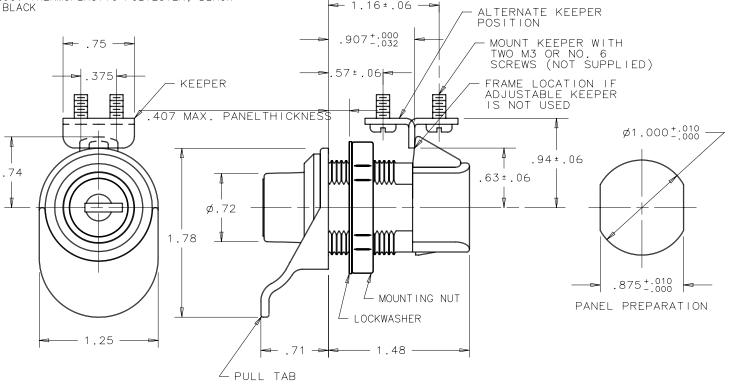
PULL TAB MAY BE INSTALLED 180° FROM POSITION SHOWN
